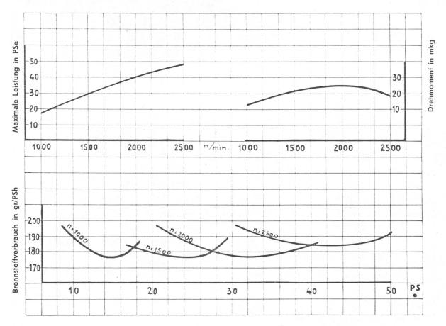
Brennstoffverbrauch (gültig für Gasöl von mindestens 10150 Cal/kg unterem Heizwert). Toleranz für Leistung und Verbrauch  $\pm$  5%. Barometer 760 mm Hg., Temp. 15% C.
