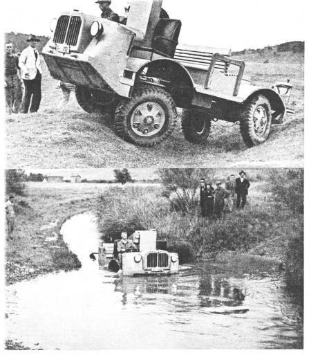
Die 4 Schwingachsen sind durch die Aufhängung miteinander verbunden. Dieser ideale Ausgleich sichert auch bei starken Unebenheiten eine gleichmässige Reaktion der 4 Räder am Boden ohne Rahmenverwindung.
