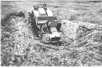
Kräftige pneumatisch-hydraulische Allradbremsen gestatten das sichere Abfangen des Fahrzeugs in Gefällen von  $70\,^0/_0$ .
