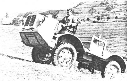
Auf dieser  $45\,^{0}/_{0}$  geneigten Halde manövrieren die M-Typen längs und quer mit derselben Leichtigkeit wie normale Fahrzeuge in der Ebene.
