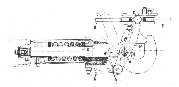
Abb. 4. Der Anhängehaken und die automatische Bremse.
