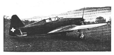
D3800 Konstrukteur: Liz. Morane. Werk: K+W. Thun u. Emmen. Baujahr: 1939/40. Material: Leichtmetall. Stahl. Stoff, Plimax. Verwendung: Jagd. Länge: 8,17 m. Höhe: 3.25 m. Spannweite: 10,61 m. Inhalt: 16 m². Leer: 1800 kg. Zuladung: 680 kg. Total: 2480 kg. 1 S.L.M.-Saurer-Motor, Lizenz Hispano-Suiza zu 860 PS. 12 Zyl. (1848).
