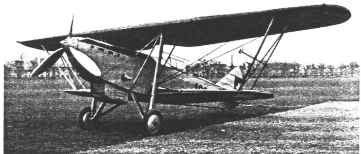
C 35 Konstrukteur: K+W, Thun. Werk: K+W, Thun. Baujahr: 1936. Material: Leichtmetall, Stahl, Holz, Stoff. Verwendung: Mehrzweck. Länge: 9,54 m. Höhe: 3,15 m. Spannweite: 13,08 m. Inhl.: 32 m 2 . Leer: 2000 kg. Zuladung: 1120 kg. Total: 3120 kg. Max.-Geschwindigkeit: 330 km/h. Steigzeit: 1000 m: 2'; 2000 m: 4,1'; 3000 m: 6,25'; 4000 m: 8,5'; 5000 m: 11,75'. Gipfelhöhe: 10 000 m. 1 S.L.M.-Saurer-Motor, Lizenz Hispano-Suiza zu 860 PS. 12 Zyl. (1848).
