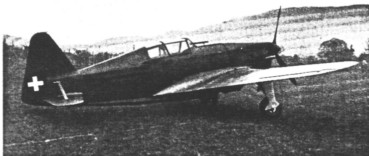
D 3800 Konstrukteur: Liz. Morane. Werk: K+W, Thun u. Emmen. Baujahr: 1939/40. Material: Leichtmetall, Stahl, Stoff, Plimax. Verwendung: Jagd. Länge: 8,17 m. Höhe: 3,25 m. Spannweite: 10,61 m. Inhl.: 16 m 2 . Leer: 1800 kg. Zuladung: 680 kg. Total: 2480 kg. 1 S.L.M.-Saurer-Motor, Lizenz Hispano-Suiza zu 860 PS. 12 Zyl. (1848).
