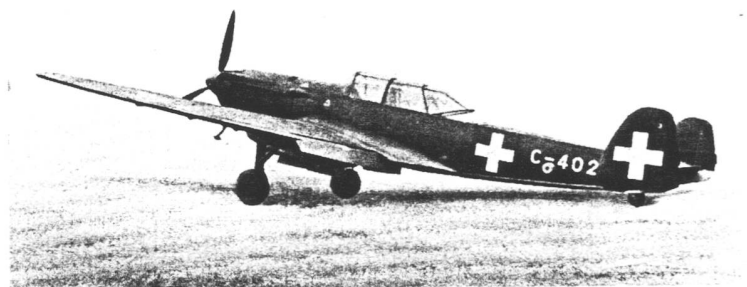
C 3603 Werk : K+W, Thun und Emmen. Baujahr : 1941/42. Material : Ganzmetall. Ruder stoffbespannt. Verwendung : Mehrzweck. Länge : 10,23 m. Höhe : 4,07 m. Spannweite : 13,74 m. Fläche : 26,0 m 2 . Total : 3457 kg. Besatzung : Pilot und Beobachter. 1 S.L.M.-Saurer-Motor. Lizenz Hispano-Suiza zu 1000 PS. 12 Zyl. Escher-Wyss vollautomatischer Verstellpropeller (1848).
