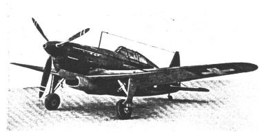
Monstrukteur: Liz. Morane. Werk: K+W, Thun u. Emmen. Baujahr: 1941. Material: Leichtmetall, Stahl, Stoff, Plimax. Verwendung: Jagd. Länge: 8,17 m. Höhe: 3,25 m. Spannweite: 10,61 m. Inhalt: 16 m². Leer: 1860 kg. Zuladung: 700 kg. Total: 2560 kg. 1 S.L.M.-Saurer-Motor, Lizenz Hispano-Suiza zu 1000 PS. 12 Zyl. (1848).
