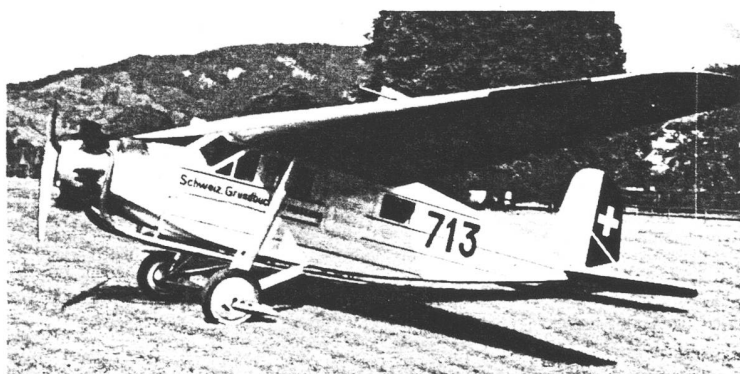
M 18 D Konstrukteur : Liz. Messerschmitt. Werk : K - W. Thun. Baujahr : 1934. Material : Dural. Stahl. Stoff. Holz. Verwendung : Vermessung. Länge : 9.43 m. Höhe : 2.91 m. Spannweite : 15.8 m. Inhalt : 25.3 m 3 . Leer : 900 kg. Zuladung : 520 kg. Total : 1420 kg. Max.-Geschwindigkeit : 175 km h. Min.-Geschwindigkeit : 99.5 km h. Steigzeit : 1000 m : 4.9' ; 2000 m : 10' ; 3000 m : 15' ; 4000 m : 20.5' ; 5000 m : 27.5' ; 7200 m : 60'. 1 Siddeley-Lynx-Motor zu 300 PS. 7 Zyl. Insgesamt hergestellt : 2 Stück. Bemerkung : 713 für Schweiz. Grundbuchvermessung. 714 für Landestopographie (1848).
