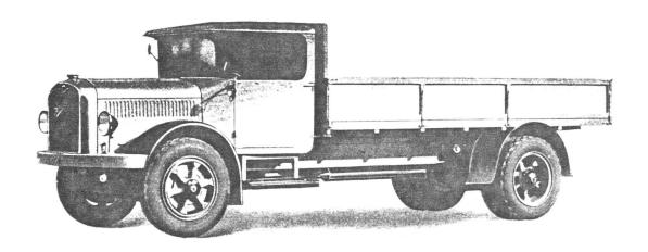
Abb. 12. 5 Tonnen Saurer-Lastwagen mit 6-Zylinder-Dieselmotor Type 5 BLD.
