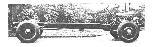
Abb. 10. Saurer-Fahrgestell mit 6-Zylinder-Dieselmotor Type 5 BLD.
