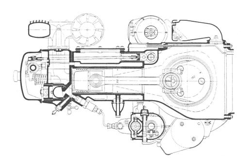
Abb. 4. Querschnitt durch den 6-Zylinder-Dieselmotor Type BLD; Maßstab 1:8,
