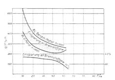
Abb. 13. Vergleich des Brennstoffverbrauchs zwischen einem Saurer 6-Zylinder-Benzinmotor Type BL und einem Saurer 6-Zylinder-Dieselmotor Type BLD.
