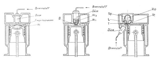
Abb. 1. Strahlzerstäubungs-Motor.  $V_c = 100\%$  direkt über dem Arbeitszylinder.
