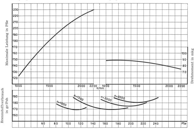
Brennstoffverbrauch (gültig für Gasöl von mindestens 10150 Cal/kg unterem Heizwert) Toleranz für Leistung und Verbrauch 5 %. Barometer 760 mm Hg., Temp. 15 ° C
