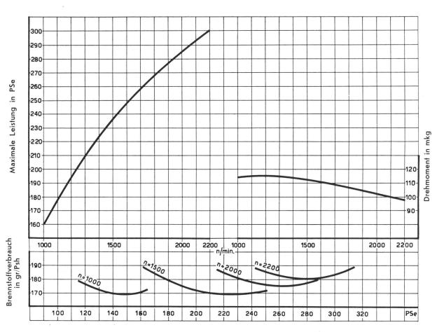
Brennstoffverbrauch (gültig für Gasöl von mindestens 10150 Cal/kg unterem Heizwert). Toleranz für Leistung und Verbrauch  $\pm$  5%. Barometer 760 mm Hg., Temp. 15% C.
