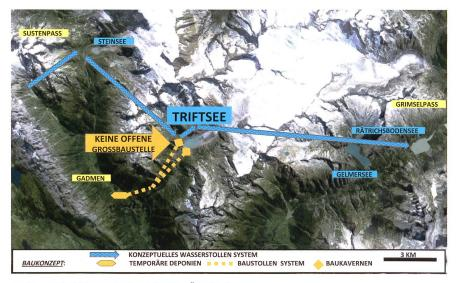
Das Konzept des Triftwasserkraftprojekts (eine Übersicht).
