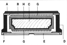
A = ABS-Oberfläche; B = Fiberglas-Torsionskasten; C = Pat. Sensorkern aus Pappelholz, mit Grenzflächenverankerung; D = ABS-Seitenwangen; E = P-tex downhill -Rennbelag mit speziellem Diamantsteinschliff; F = Bioflex-Stahlkante, extraschmal, grössere Belagfläche; G = Alulegierung «Perradur S»; H = Doppeltorsionskasten; J = «Perradur S»-Oberkanten.
