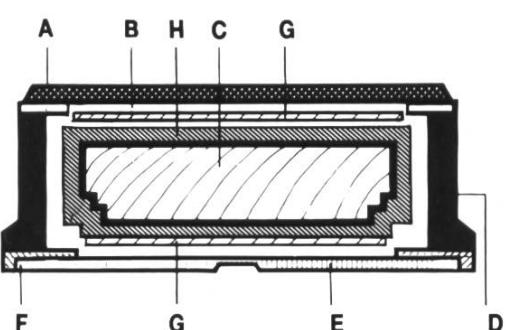
A = ABS-Oberfläche; B = Fiberglas-Torsionskasten; C = Pat. Sensorkern aus Pappelholz, mit Grenzflächenverankerung; D = ABS-Seiterwangen; E = P-tex downhill - Rennbelag mit speziellem Diamantsteinschliff; F = Bioflex-Stahlkante, extrasmal, grössere Belagfläche; G = Alulegierung «Perradur S»; H = Doppeltorsionskasten; J = «Perradur S»-Oberkanten.
