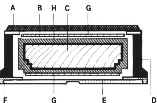
A = ABS-Oberfläche; B = Fiberglas-Torsionskasten; C = Pat. Sensorkern aus Pappelholz, mit Grenzflächenverankerung; D = ABS-Seiterwangen; E = P-tex downhill - Rennbelag mit speziellem Diamantsteinschliff; F = Bioflex-Stahlkante, extrasmal, grössere Belagfläche; G = Alulegierung «Perradur S»; H = Doppeltorsionskasten; J = «Perradur S»-Oberkanten.
