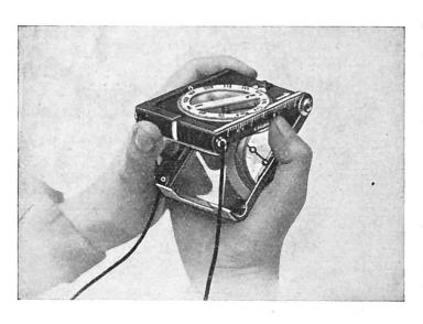
Die vollkommen neuartige Spiegelanordnung in Verbindung mit der transparenten Bussolendose erzeugt bei Verwendung im Terrain ein ausserordentlich helles und klares Bussolenbild, so dass das Anschneiden von Geländepunkten selbst bei tiefer Dämmerung oder Nacht leicht zu bewerkstelligen ist. Die Visur ins Gelände geschieht frei und unbehindert über eine Zielvorrichtung mit Korn und Visier. Die Uebertragung von Marschrouten aus der Karte ins
