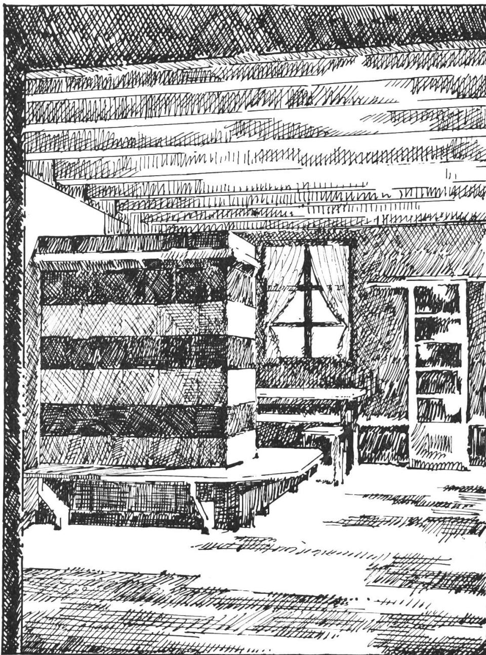
Räume bedingt. Der «Gwättbau» besteht in einem Gefüge von aufeinander geschichteten und ineinander verstrickten Balken, die unter sich durch Holzfedern fest verbunden sind und allen erforderlichen Schutz gegen Wind und Kälte bieten. Das Dach ist mit schmieg-samen Holzschildeln abgedeckt und nur im Bereich der Kamine zum Schutz vor Feuersgefahr mit Eternitplatten versehen. An den
