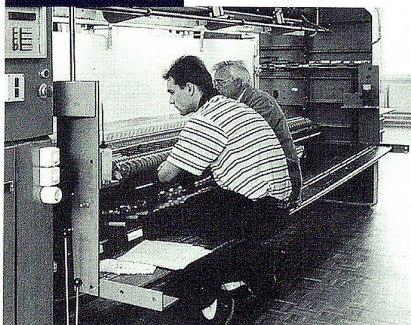
Einlaufenlassen der Dessins und überprüfen der Stickfunktion. First production of a new design and general check of the embroidery machine functions.
