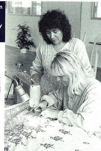
Ausbessern von Fehlern auf den gestickten Stoffen. Mending of embroidery faults on embroidered fabric.
