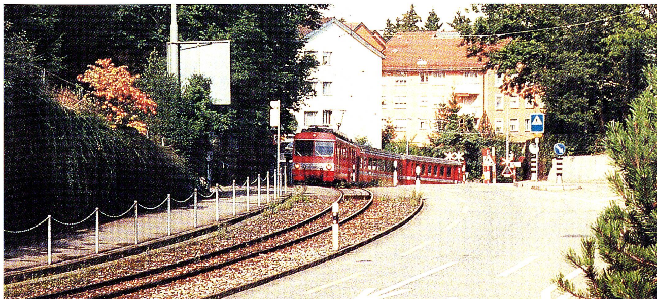
Weit über eine Million Reisende pro Jahr benützen die 72 Züge pro Tag für die Fahrten von und nach St.Gallen. Entlang der im Bild sichtbaren Teufenerstrasse erfordert die Steigung den Zahnradbetrieb. Als besonders problematisch erweisen sich die Zahnstangeneinfahrten (Lärm beim Einfahren der Zahnräder in die Zahnstange) und die Ölverluste der Zahnräder im Schotterbett. Nur drei der vierzehn Bahnübergänge sind mit Sicherungsanlagen ausgerüstet, bei zwei Bahnübergängen müssen die Autos überdies über die Zahnstange in Sonderkonstruktion fahren.
