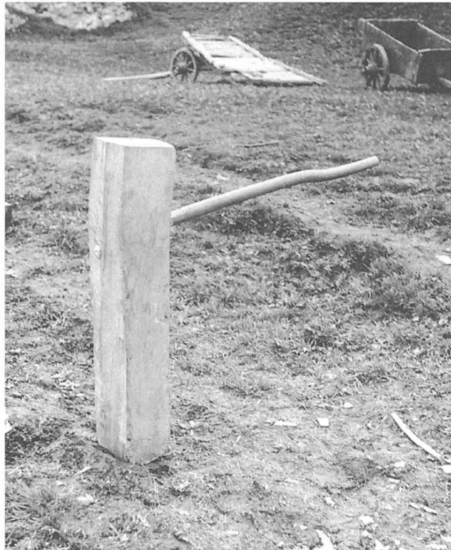
Nr. 1: Cuolm la Casa . – Auf dem Bauplatz eines neu zu erstellenden Stalls und Heugadens. Augenfällig die Einfachheit dieses Geräts: Die Wandbalkenhaue , romanisch: il mogn de preit . (Foto: A. Maissen, 1941)
