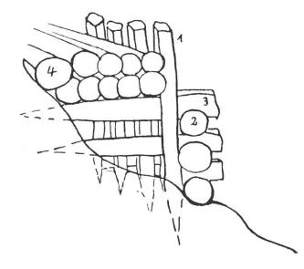
Abb. 26: Hebaufpalisade zum Sammeln der Blöcke. 1. pisuns, passuns. 2. solas, subigias. 3. banca, banchina, sutga. 4. buoras.
