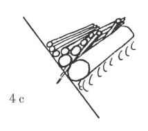
Abb. 4 a, b, c: Hanggeleit ohne Unterbau mit verstärkter Aussenwand.
