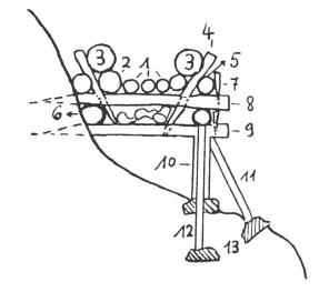
Da im allgemeinen die Bestandteile eines *irals* nicht verdübelt, vernagelt oder mit Bundhaken befestigt wurden, erhielten Verbindungsstellen Abplattungen, Einkerbungen usw. (Abb. 8 a, b, c) und die Stützen und Pfeiler Ausbuchtungen im Stirnstück, *bucca bulza*, *pecaura* (Abb. 8 c).
