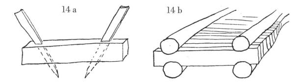
Abb. 14: a) Geleitbahnen in Form von Wagenkissen mit Hörnern sutga, plumatsch cun corns, cornera. b) Geleitbahn in Form von Bachbrücken, sogenannte supias de Rein.
