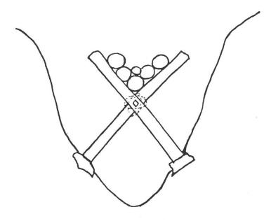
Abb. 18: Vorzugsweise in Senkungen, Schluchten, Vertiefungen werden solche Geleitböcke erstellt (Andreaskreuzbock). Die beiden Kreuzbalken werden mit 20 mm dicken Mutterschrauben befestigt und mit Draht und Bundhaken verstärkt. Die Spundhölzer cassas entsprechen etwa der Dicke eines Heugadenträmels.
