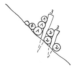
Abb. 24: Hebaufprofil einfacher Art. 1. Stützwand spunda, cassa. 2. Hebaufbäume solas, curvias, subigias. 3. Pfähle spruns. 4. Bodenstücke aus Latten usw.
