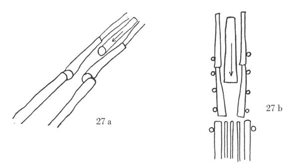
Abb. 27: a) b) Bremszange, im Geleit eingebaut. Sie kann bremsen, aber auch über Hindernisse zum nächsten Geleitstück werfen.
