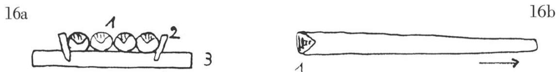
Abb. 16: Ohrenries im Val Sampuoir. 1. Läufer mit Ausbuchtungen (Ohren) im dicken Stirnholzstück, worin das dünne Ende des oberen Läufers aufliegt. 2. Holznägel 20–25 cm lang, 15–25 mm dick. 3. Bockbaum, alle 5 m ein Stück.
