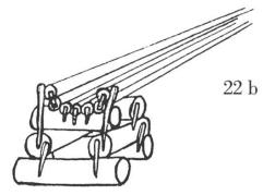
Abb. 22: a) Geleitbock mit Lattengeleit aus Martinach. Alle Teile sind durch zugespitzte und eingeschlagene Holznägel miteinander verbunden. Hier nur der Vorderbock. b) Weitere Art der vielen Böcke mit Gleitlatten, die eine grosse Holzrutschbahn braucht. Martinach.
