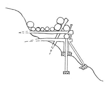
Abb. 6: Geleit mit seitlichen Unterbau und verstärkter Aussenwand.
