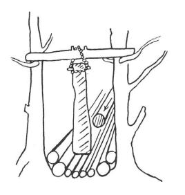
Abb. 29: An Bäumen oder Gerüsten aufgehängter Baumklöppel als Bremser und Warner.
