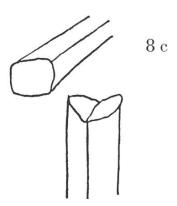
Abb. 8: a) 1. Banchina mit Abplattung. 2. Stütze. 3. Stützstein. 4. Bockträmel. b) 1. Banchina, traversal mit Ausbuchtung. 2. Pfosten mit geissfussförmiger Ausbuchtung pecaura. 3. Tragträmel, etwas abgeplattet subigia. 4. Holznagel darschun. c) Stütze mit Geissfuss pecaura.
