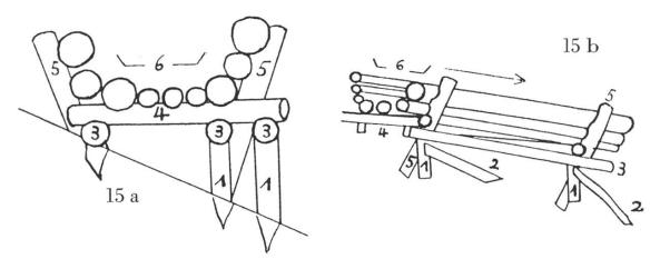
Abb. 15: a) Profil eines Eralbaues im Engadin. b) Geleitzug in Stellung. 1. calunet. 2. tenda. 3. subigia. 4. traversal. 5. tenda. 6. bancha. (2 Abb. aus DRG.)
