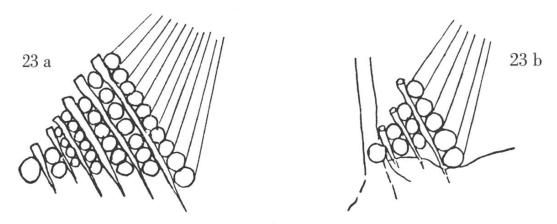
Abb. 23: a) Grosse Hebaufwand, Verlege- oder Sammelstelle arca, archa. b) Kleinere arca, auch spatla oder archetta, fratga genannt. c) Zwischen- oder Schlussstück eines Geleits mit Bremsklöppel, Auswurfstelle und nachfolgender spatla und arca. Das Holz geht dann zur Sammelstelle a mantun, muntanar.
