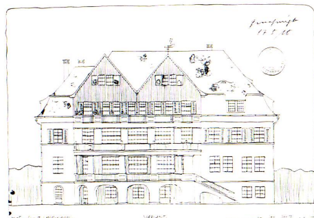
Entwurfszeichnung für das Hotel «Schiff» in Langenargen von Architekt Zimmermann in Ravensburg mit regionalistischen Zutaten wie Giebel, Verbretterung und Sprossenfenstern. Kopie Kreisarchiv Bodenseekreis.
