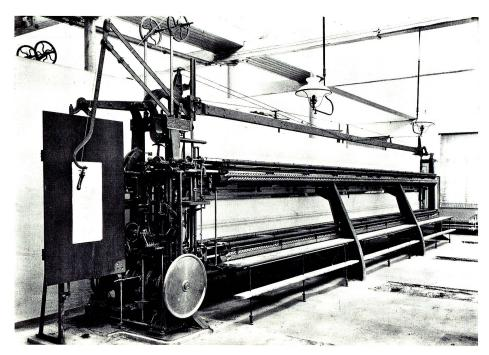
10-Yards-Schifflistickmaschine, Modell 1910, Photo Saurer AG, Arbon.
