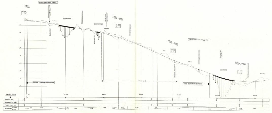
An der Form der Unterführung «Linkolnsbergstraße» kann man die Staffelung der Fahrbahnen erkennen. Durch die Unterführung «RHB» wird die Kreuzung der Rorschach—Heiden-Bahn mit der Autobahn gewährleistet. Die ca. 10 m breite Baustraße ermöglicht einen einwandfreien Längstransport der Dammschüttungsmaterialien, ohne die öffentlichen Straßen benützen zu müssen. Westlich der «RHB» ist bereits ein Teil der Felsfilterschicht eingebracht. Foto Walter Baer.
