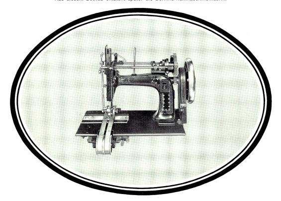
Die erste Hohlsaumnähmaschine der Welt, erfunden von Fritz Gegauf, dem Gründer der nachmaligen Bernina-Nähmaschinenfabrik, Steckborn. Diese Hohlsaumnähmaschine erhielt am 1. September 1893 das Schweiz. Patent Nr. 7281.
