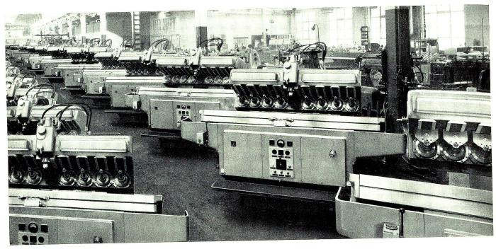
Montagehalle der STARR-Spezial-Fräsmaschinen Type ST für Turbinenschaufeln
