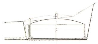
Abb. 8. Wasserbehälter Sulzberg. Querschnitt Kammer IV.
