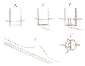
Abb. 2. Skizze Brunnenstuben. A = frühere, B = spätere, C und C' = neuzeitliche Ausführung.
