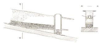
Abb. 1. Skizze Quellfassung. Längen- und Querschnitt.
