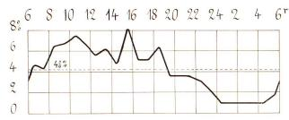
Abb. 6. Tagesschwankungen im Wasserverbrauch des Niederdrucknetzes, 15./16. Mai 1936.
