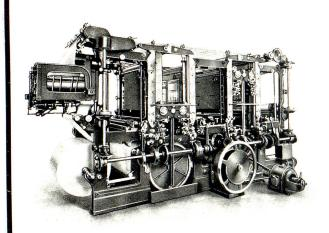
Praktische Zeitungsmaschine für kleine und mittelgrosse Auflagen (8, 6, 4 und 2 Seiten). Liefert auch guten Werk- und Bilderdruck, Prospekte, Kalender, Fahrpläne, Telephonbücher usw. — Zugänglichkeit, einfachste Bedienung, leichtes Korrigieren, bequemes Einheben der Form, billiger Betrieb.
