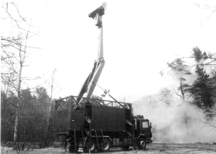
Les censeurs, capteurs et radars de surveillance ont rendu le champs de bataille lisible. Ici, le radar suédois Girafe couplé à un système C<sup>3</sup>I...
