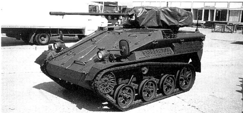
porteurs, 1 galet-support, 1 barbotin à l'avant, une poulie de renvoi à l'arrière à la hauteur des galets porteurs. Les chenilles sont des rubans de caoutchouc d'un seul tenant. La suspension est à barres de torsion, amortisseurs hydrauliques et butées de fin de course.
