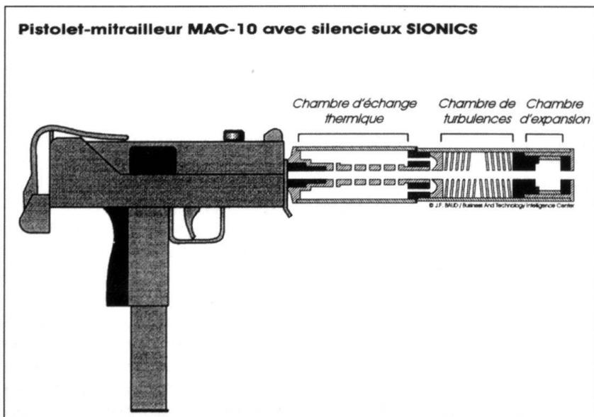
des matériaux joue un rôle important sur la durée de vie du silencieux. En effet, il est soumis à des contraintes mécaniques et thermiques importantes et il devrait conserver ses propriétés sans exiger des travaux d'entretien trop fréquents.
