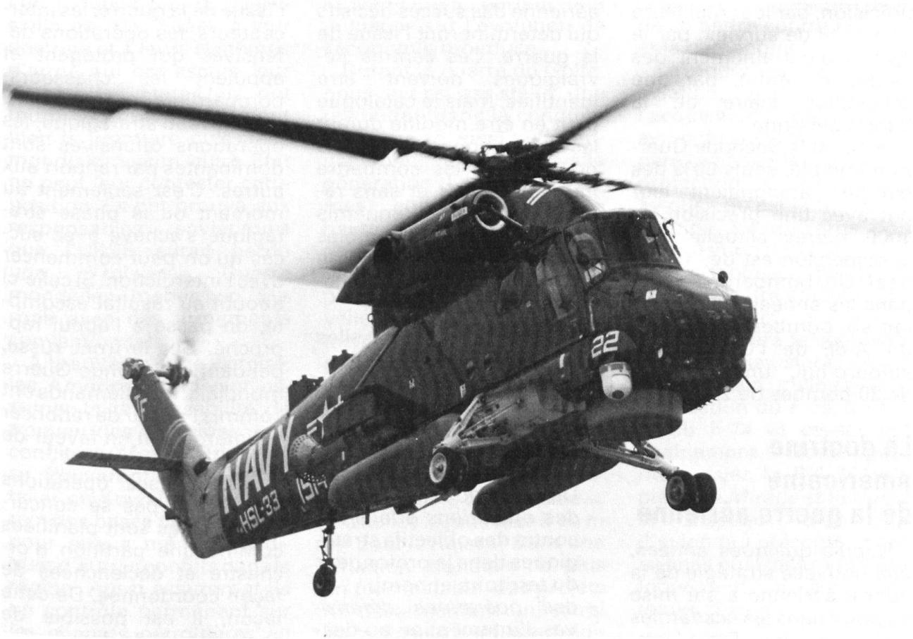
*Les systèmes d'arme engagés contre l'Irak étaient aptes aussi bien au combat de jour que de nuit. Ici, un hélicoptère de l'US Navy équipé d'un dispositif de vision de nuit que l'on distingue au-dessous du poste de pilotage. (Photo Hughes Aircraft Company)*
