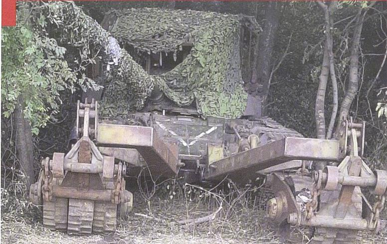
Ci-contre et page suivante : Afin de préserver leurs ressources, les forces russes ont construit des abris pour leurs engins de combat. Ceux-ci sont également protégés, durant le mouvement, par des blindages espacés souvent désignés en tant que "cope cages" permettant de se protéger contre l'approche de drones ou l'exposition de munitions à courte distance.
