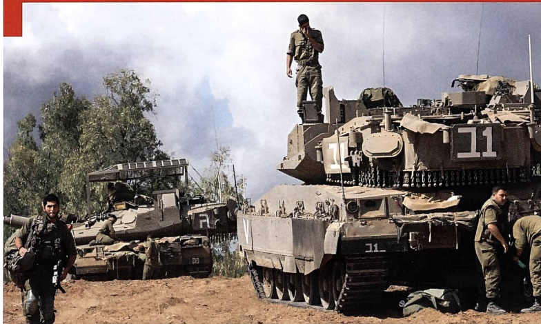
Deux Merkava 4M au moment d'établir la préparation au combat. Les panneaux radars ainsi que les deux lanceurs, sur les flancs de la tourelle, sont bien visibles, de même que les blindages additionnels.
