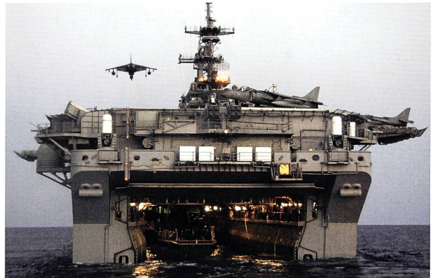
Ci-dessus : La comparaison du LHA 6 et du LHD-3 montre l'absence ou la présence du dock et du radier, permettant l'embarquement et de chalands ou la mise à la mer de tracteurs amphibies ( amtracks ).
