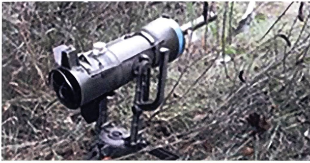
Mine antichar (PARM HEAT DM12). Sur le principe, il s'agit d'un bazooka sur affût et déclenché à distance.
