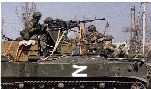
Ci-dessus: Deux vues du BTR-D, la version de transport de troupes ou de matériel de la famille BMD. Cet engin peut également servir de poste de commandement ou de plateforme pour certaines armes d'appui – à l'instar du BTR-ZD Shrezhet sur lequel est fixé un canon anti-aérien ZU-23/2.
