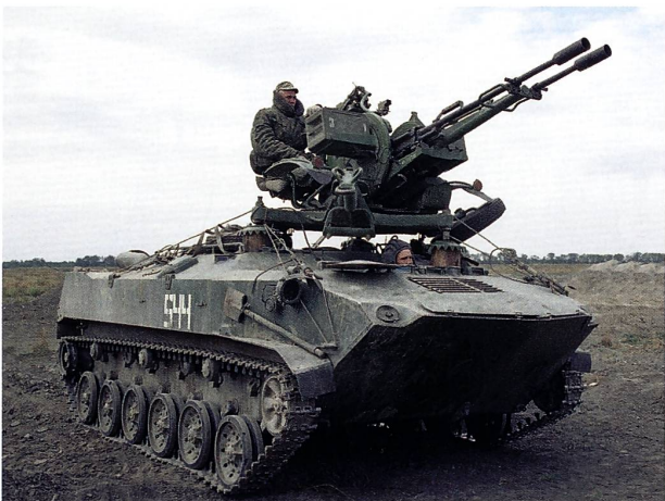
Ci-dessus: Deux vues du BTR-D, la version de transport de troupes ou de matériel de la famille BMD. Cet engin peut également servir de poste de commandement ou de plateforme pour certaines armes d'appui – à l'instar du BTR-ZD Shrezhet sur lequel est fixé un canon anti-aérien ZU-23/2.
