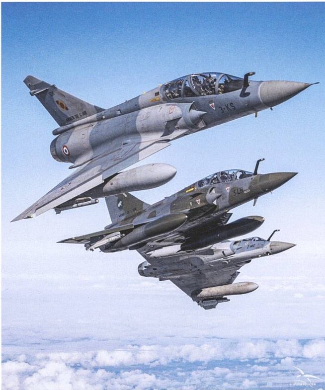
Trio de Mirages 2000 – Celui du premier plan est un biplace B d'entraînement. Le biplace au centre est un D optimisé pour l'attaque au sol. Et celui du fond est un 2000-5 sensiblement amélioré pour la défense aérienne.
