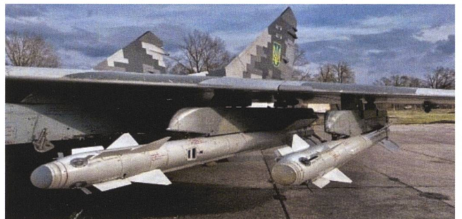
Certains MiG-29 ont reçu de nouvelles couleurs, pour camoufler leur origine et pour être plus facilement identifiés par la défense sol-air amie. Les limites de ces appareils – rayon d'action, manque de polyvalence, courte portée des armes – sont bien connues. Photos © Forces aériennes ukrainiennes.
