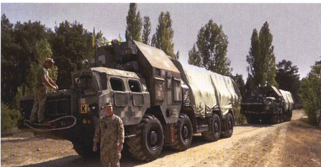
Lanceur de S-300 ukrainien. Chaque batterie compte plusieurs lanceurs, un radar de veille et un autre de conduite de tir, ainsi que plusieurs véhicules spécialisés. (forces armées ukrainiennes).
