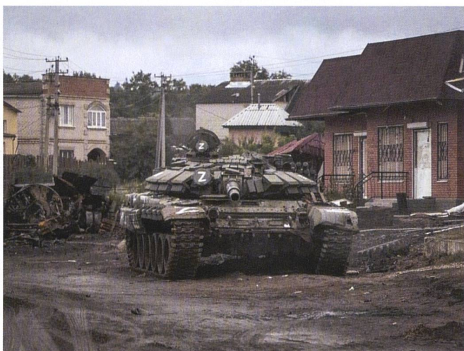
Ce T-72 B3 a reçu quelques blocs de blindages supplémentaires Kontakt 1 d'ancienne génération, afin de réduire les lacunes de protection sur l'avant et le toit de la tourelle.
