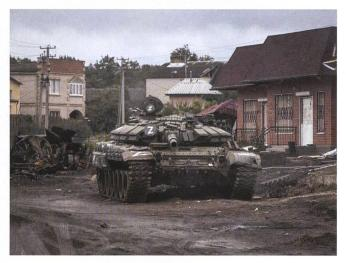
Ce T-72 B3 a reçu quelques blocs de blindages supplémentaires Kontakt 1 d'ancienne génération, afin de réduire les lacunes de protection sur l'avant et le toit de la tourelle.
