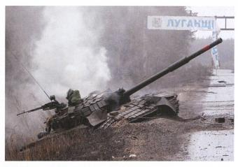
Un T-72 B recouvert de blindages réactifs Kontakt 1 sort de sa position de feu. Malgré les vitesses de pointe élevées, supérieures à 60 km/h sur route, tous les T-72 et T-90 sont limités par une boîte de vitesse ne disposant que d'une seule marche arrière, limitée à 5-6 km/h.
