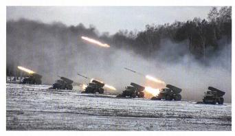
Tir d'une batterie complète de BM-21. Chaque véhicule peut tirer 40 fusées à une distance de 17 km au maximum, à un rythme de deux coups par seconde.
