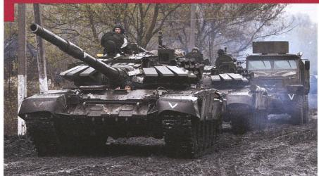
Malgré l'emploi de quelques engins relativement modernes, la grande majorité des moyens employés par les belligérants date des années 1970-1980. Ces T-72 B3 russes ont reçu des blindages réactifs dans les années 2010 (Kontakt 5) ainsi qu'une caméra thermique d'origine française, visible sur le côté gauche de la tourelle. Mais les performances restent modestes car les finances russes et la corruption n'ont pas permis de remplacer ou de moderniser efficacement les milliers d'engins en service.
