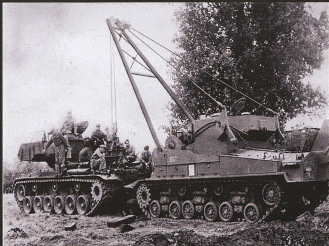
Un M-74 de dépannage dépose le moteur d'un M-47.
