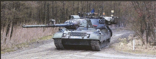
Léopard 1A5 (BE) équipé d'une conduite de tir SABCA, dont le tourelleau blindé est bien visible au-dessus du poste du pointeur. La modernisation belge inclut également une conduite de tir issue du Leo 2 ainsi que des blindages supplémentaires (tabliers lourds).
