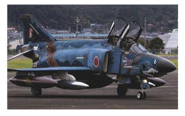
explique sa livrée et son redimensionnement – permettant d'emporter simultanément quatre missiles ASM.
