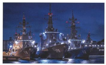
Les destroyers JS Fuyuzuki (DD-118) Myôkô (DDG-175) et Makinami (DD-112) déplacent entre 4'700 et 7'250 tonnes. Les deux premiers sont dotés de radars Aegis et sont basés sur un design américain. Photos © JMSDF.
