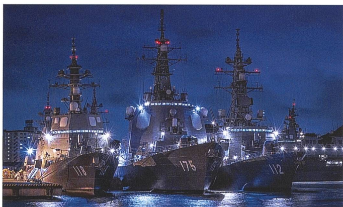
Les destroyers JS Fuyuzuki (DD-118) Myōkō (DDG-175) et Makinami (DD-112) déplacent entre 4'700 et 7'250 tonnes. Les deux premiers sont dotés de radars Aegis et sont basés sur un design américain. Photos © JMSDF.
