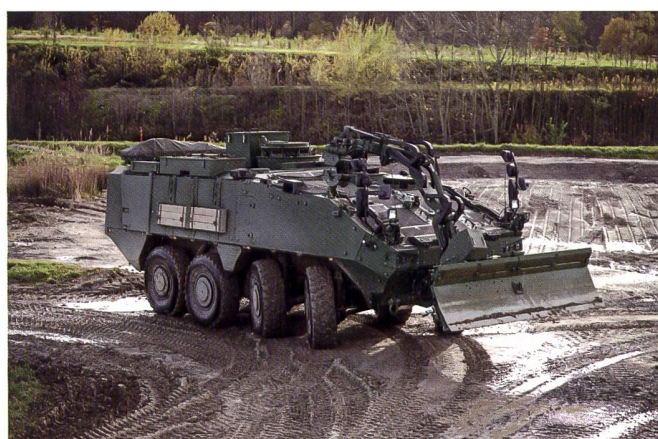
Ci-dessous: L'engin est en mesure d'assurer des missions d'appui à la mobilité avec un bras articulé, une lame ou encore une charrue de déminage.
