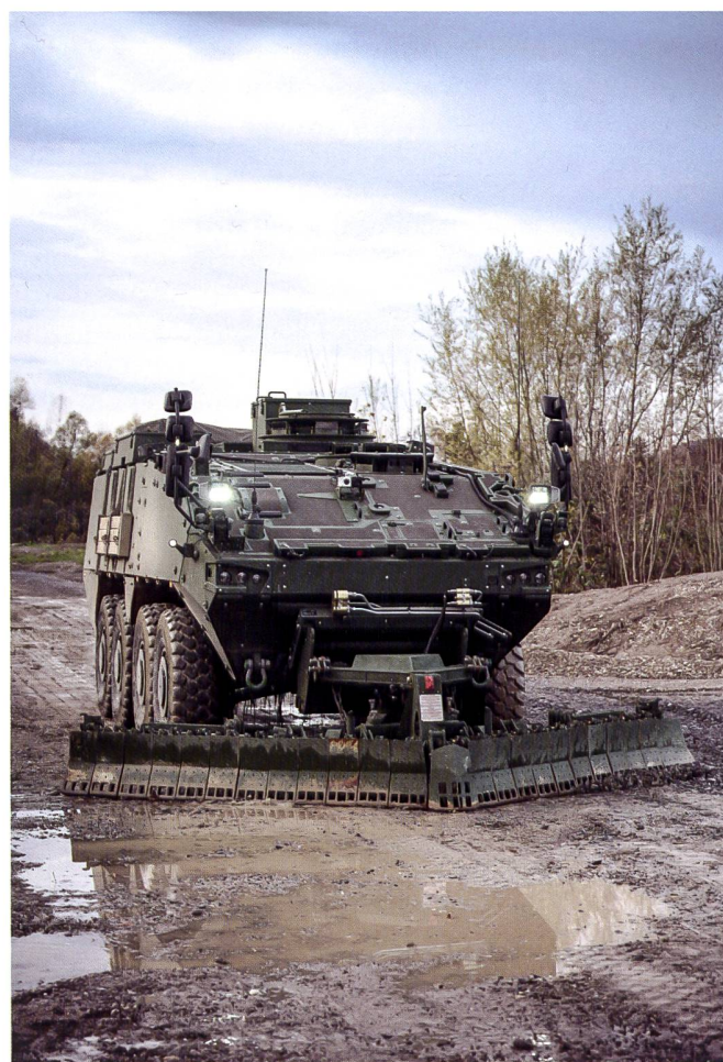
Ci-dessous: L'engin est en mesure d'assurer des missions d'appui à la mobilité avec un bras articulé, une lame ou encore une charrue de déminage.
