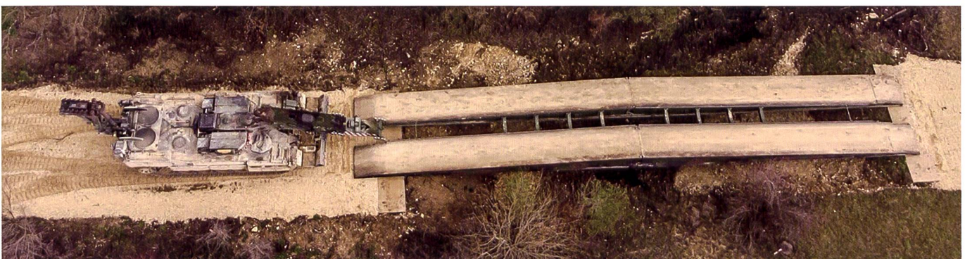
Engagement du char poseur de pont Leguan , sur le châssis du Léopard .
