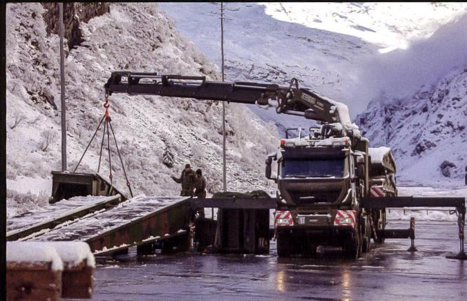
Avec chacun des six *Leguan*, le bataillon dispose d'un camion transportant et également capable de poser un deuxième pont.
