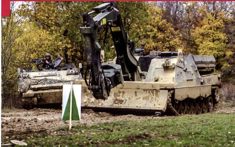
Une section de sapeurs de chars se compose de quatre chars du Génie 63 – ci-contre – sur la base du M-113. A l'origine, ceux-ci étaient équipés d'une lame à l'avant pour le déblaiement. Après cinquante ans de bons et loyaux services, ceux-ci doivent être remplacés par des engins plus mobiles, mieux protégés et capables d'emporter davantage de matériel. Les sections servent à assurer et à appuyer l'engagement de moyens lourds – à l'instar de ce char du Génie *Kodiak*.
