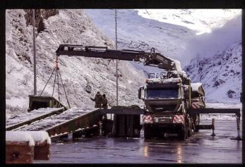
Avec chacun des six *Leguan*, le bataillon dispose d'un camion transportant et également capable de poser un deuxième pont.
