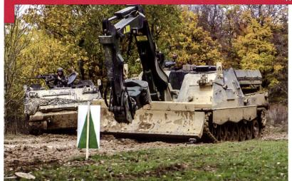
Une section de sapeurs de chars se compose de quatre chars du Génie 63 — ci-contre — sur la base du M-113. A l'origine, ceux-ci étaient équipés d'une lame à l'avant pour le déblaiement. Après cinquante ans de bons et loyaux services, ceux-ci doivent être remplacés par des engins plus mobiles, mieux protégés et capables d'emporter davantage de matériel. Les sections servent à assurer et à appuyer l'engagement de moyens lourds — à l'instar de ce char du Génie Kodiak.
