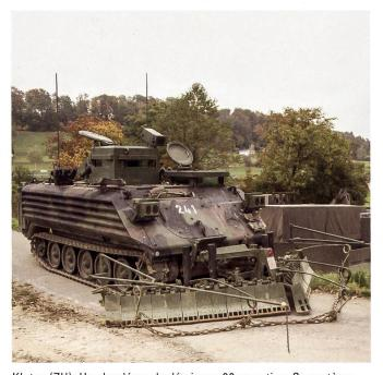
Kloten (ZH): Un char léger de déminage 00 en action. Ce système permet de faire détonner à distance des mines via des émetteurs fixés à l'avant du châssis, ainsi que par une chaîne. Les mines et explosifs sont ensuite poussés sur les côtés par une lame modulaire. Et enfin l'itinéraire de franchissement peut être marqué par un dispositif de peinture monté à l'arrière.
