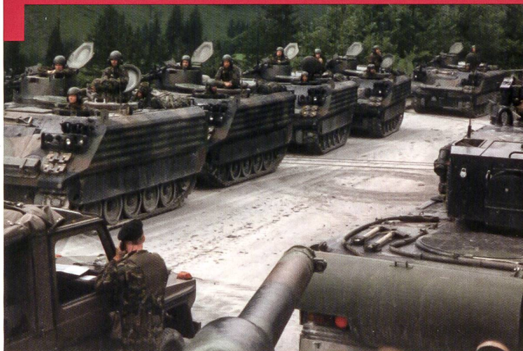
Wichlen (GL) en 1998: Le engins de la compagnie de grenadiers de chars IV/17. Le canon de 20mm pouvait être engagé contre des buts terrestres et aériens – dans ce dernier cas à l'aide d'un viseur métallique et par le biais de l'écouille ouverte.
