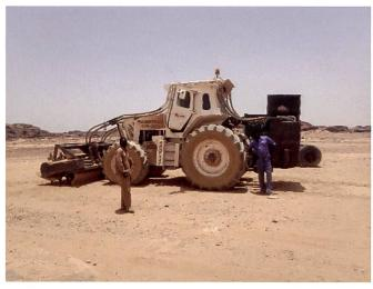
Engin de déminage mécanique, Tchad 2015.
