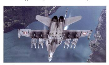
Ce F/A-18 au-dessus du lac dd Brienz effectue des essais en vol pour l'emport de 8 missiles air-air à moyenne portée AMRAAM.
