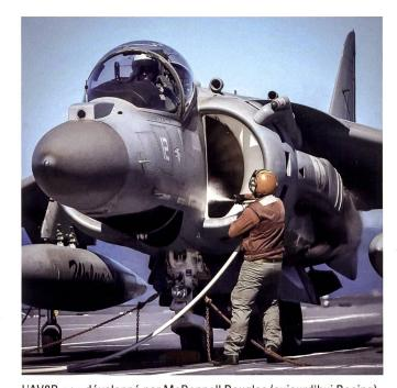
L'AV8B «+» développé par McDonnell Douglas (aujourd'hui Boeing) comporte non seulement des capteurs optiques et de télémétrie dans le nez: celui-ci a été élargi afin d'installer un radar multimodes APG-65 issus des F/A-18 A/B de l'USMC. Ce radar très performant permet donc à ce petit aéronef d'engager le combat au-delà de l'horizon, avec ses missiles AIM-120 AMRAAM. Toutes les photos © Marine italienne.
