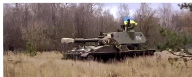
Une batterie d'obusiers autopropulsés 2S1 Gvozdika (oeillet) se prépare au tir ; l'engin emporte une arme de 122 mm. En bas, un 2S3 Acacia armé d'une pièce de 152 mm.
