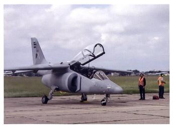
Le FMA IA-63 *Pampa* II est un avion d'entraînement et d'attaque léger. La troisième génération (Phase 3) de cet appareil serait susceptible d'emporter 650 kg de charges offensives sur cinq pylones.
