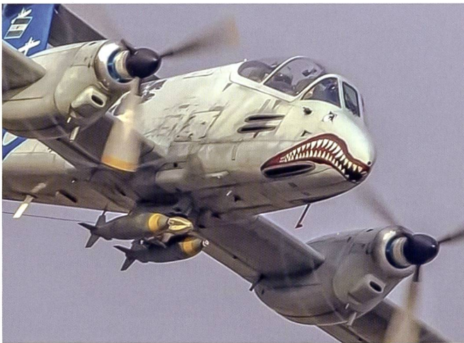
Le FMA IA58 Pucar est un appareil d'appui aérien rapproché armé de quatre canons de 20 mm et capable d'emporter une panoplie de bombes et de roquettes sur trois points d'attache, pour un poids d'1,6 tonnes au maximum. Cet appareil développé en Argentine et construit à 110 exemplaires aurait pu représenter un danger considérable aux troupes britanniques. La plupart de ces appareils ont cependant été neutralisés au sol, par des raids aériens ou de forces spéciales britanniques.
