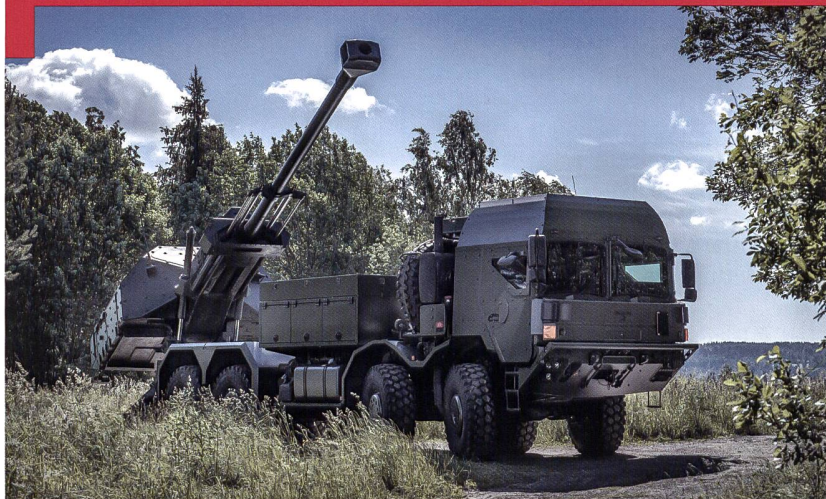
Ci-contre : Archer de BAE Systems, monté sur un camion Rheinmetall 8x8. Source : BAE Systems.
