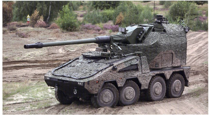
Ci-dessus: RCH 155 de l'Allemand Krauss-Maffei Wegmann monté sur un châssis 8x8 Boxer.
