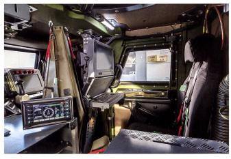
Intérieur de la cabine de l'Eagle V 6x6 TASYS avec la station INTAFF sur la place arrière droite et la station de commande du système d'arme KONGSBERG sur la place avant droite. \$il est possible de faire coulisser de gauche à droite la manette de contrôle de la KONGSBERG, cette dernière pouvant s'adapter ainsi aux gauchers comme aux droitiers.
