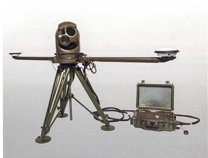
La WESCAM MX RSTA démontée du mât du véhicule et fixée sur son trépied.
